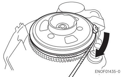
5. Ate un lazo en el otro extremo de la cuerda de arranque de emergencia y una llave de tubo. Tanto el lazo como la llave se incluyen en el kit de herramientas del motor fueraborda.
