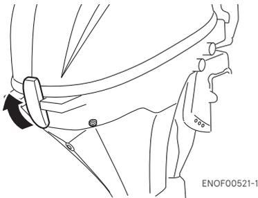
2. Extraiga el cable de bloqueo del arranque del arrancador soltando el tornillo del cable de bloqueo del arranque.
