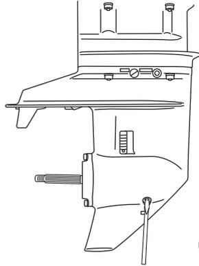
3. Inserte la boquilla del tubo de aceite en el orificio del tapón inferior y llénelo con aceite para engranajes apretando el tubo de aceite hasta que salga aceite por el orificio del tapón superior y las burbujas hayan desaparecido para eliminar el aire.
