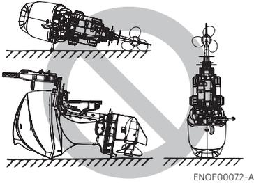
Al transportar el motor fueraborda manténgalo en una posición vertical.
