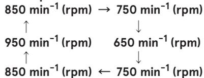
El zumbador emite un sonido breve cuando la velocidad del motor se establece en  $650 \text{ min}^{-1}$  (rpm), lo que indica que se ha fijado la velocidad mínima de caceo.
