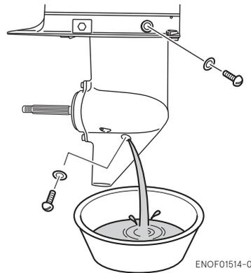
3. Inserte la boquilla del tubo de aceite en el orificio del tapón inferior y llénelo con aceite de engranajes, apretando el tubo de aceite hasta que salga aceite por el orificio del tapón superior. Asegúrese de que no salgan burbujas del orificio del tapón superior y de que no haya aire dentro de la caja de marchas.
