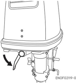
2. Desconecte la conexión de la varilla de bloqueo del arranque.
